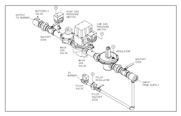
FIGURE 1-11. Typical Gas Train for LHO/LHL Systems (V35-63) & Full Mod Systems (V35-168)
