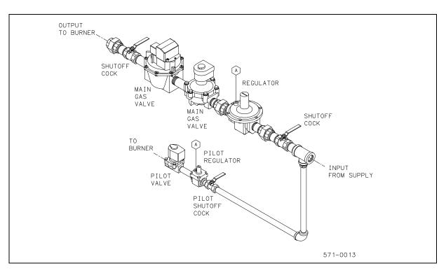
FIGURE 1-9. Typical Gas Train for LHO System (V13-34)
